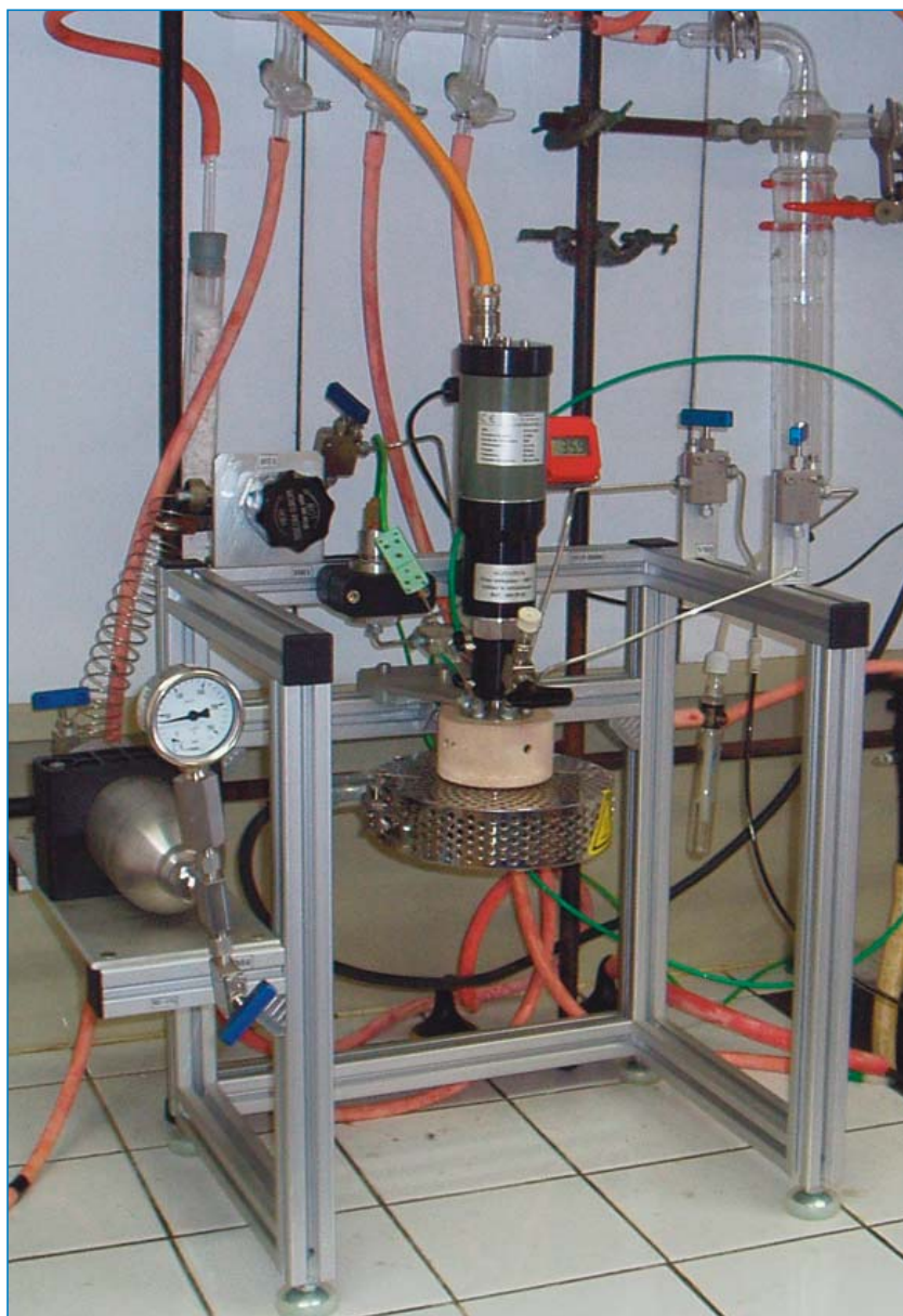
Fig 5 : Dispositif pour réaction catalytique sous pression. (©HFA/CNRS)
