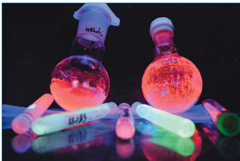
Fig 1 : Complexes organiques de terbium et d'euporium luminescents en présence d'un rayonnement UV (©CNRS/Cyril Fréssillon)
