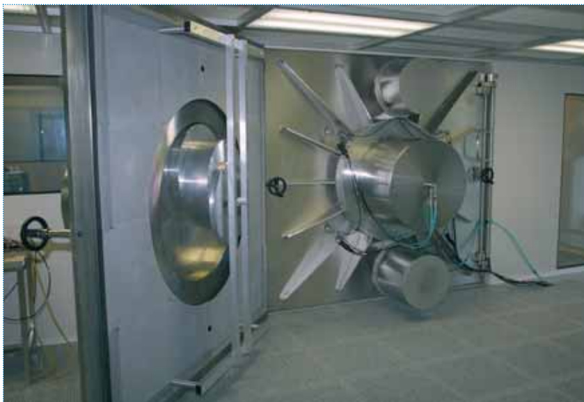
Le Grand Coater pour miroirs VIRGO (pulvérisation par faisceaux d'ions)
