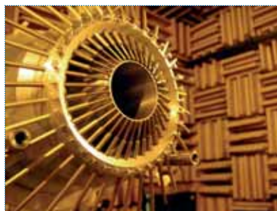
Figure 3 : Jet à mach 0.9 entouré de 36 microjets qui perturbent la zone de mélange proche de la buse afin de diminuer le bruit émis, Thèse T. Castelain, ECL 2006.
