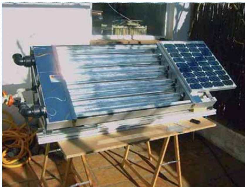
Photoréacteur pilote solaire autonome pour la potabilisation de l'eau
